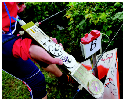
Obr. 1. Přijímač ROB pro pásmo 144 MHz typu Superfox 145E z dílny Jiřího Marečka, OK2BWN, a lampión, označující hledaný vysílač
